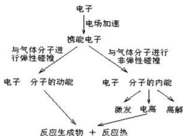
图 6.1-4 低温等离子装置工作原理示意图
