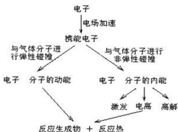
图 6-2 低温等离子装置工作原理示意图
