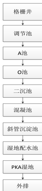
图 2-1 小山干工业区污水处理站处理工艺
